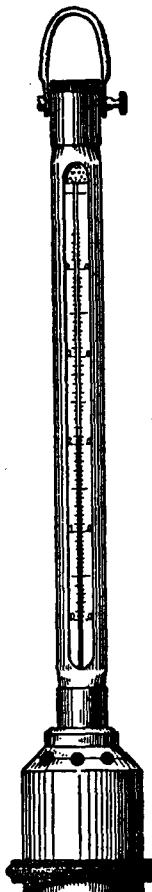
Сл. 40. Термометар за мерење температуре воде
