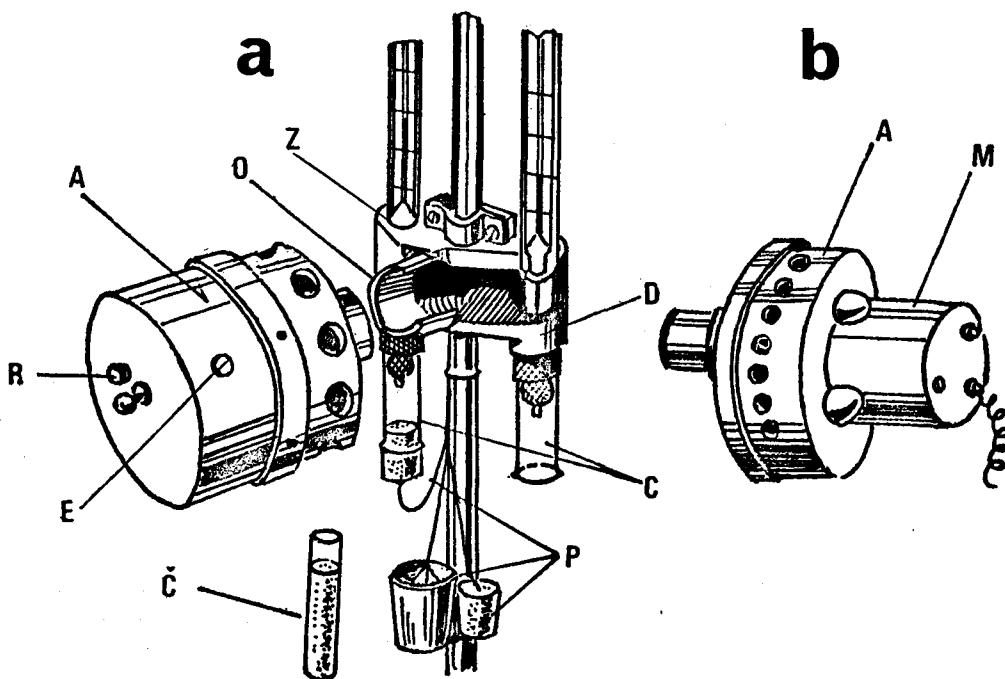
Сл. 45. Механички усисач за проветравање оба термометра
