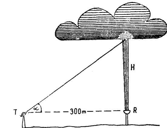
Сл. 83. Мерење висине облака помоћу рефлектора
