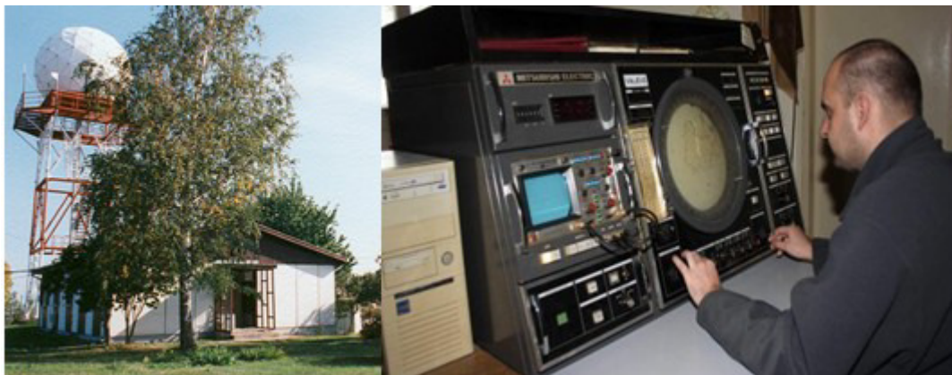
Kupola radara Micubiši na RC Valjevo i njegova upravljačka konzola
