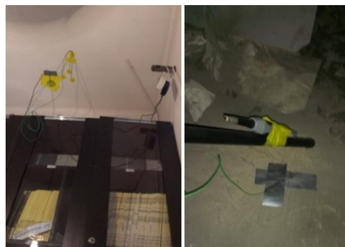
Слика 4.17 Приказ мерења топлотног флукса и температуре за међуспратну конструкцију ка негрејаном таванском простору (слика лево - унутрашње мерење, слика десно - мерење на тавану)
