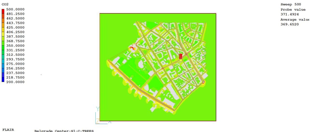
Слика 6.8 Полье концентрације угљен-диоксида у ваздуху на висини 1,85 метара за случај S1-C
