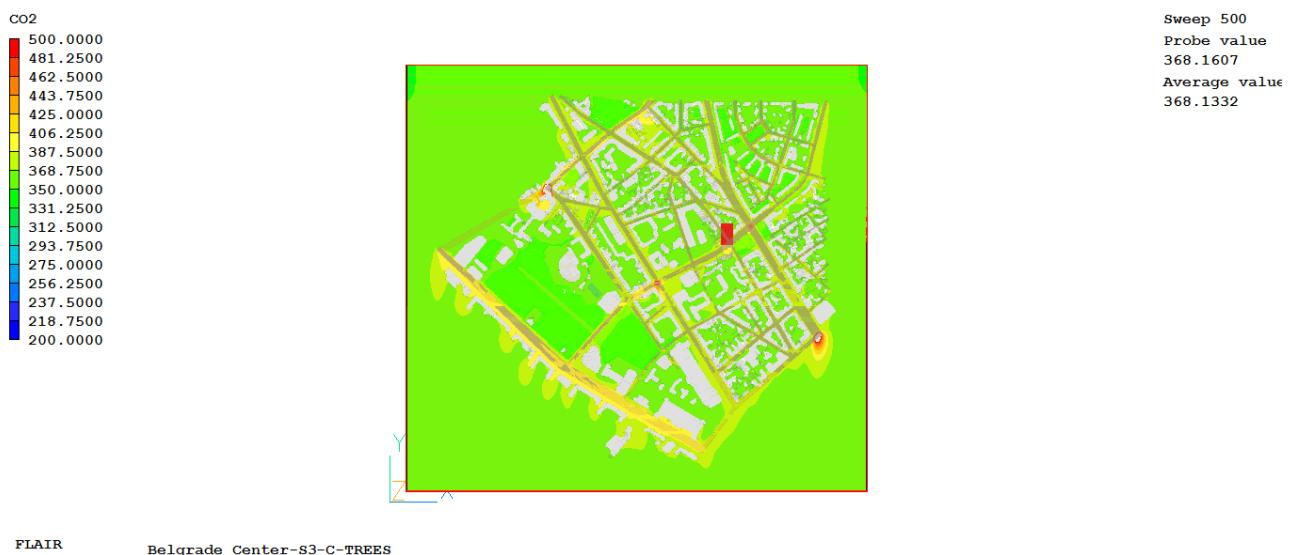
Слика 6.18 Поље концентрације угљен-диоксида у ваздуху на висини 1,85 метара за случај S3-C
