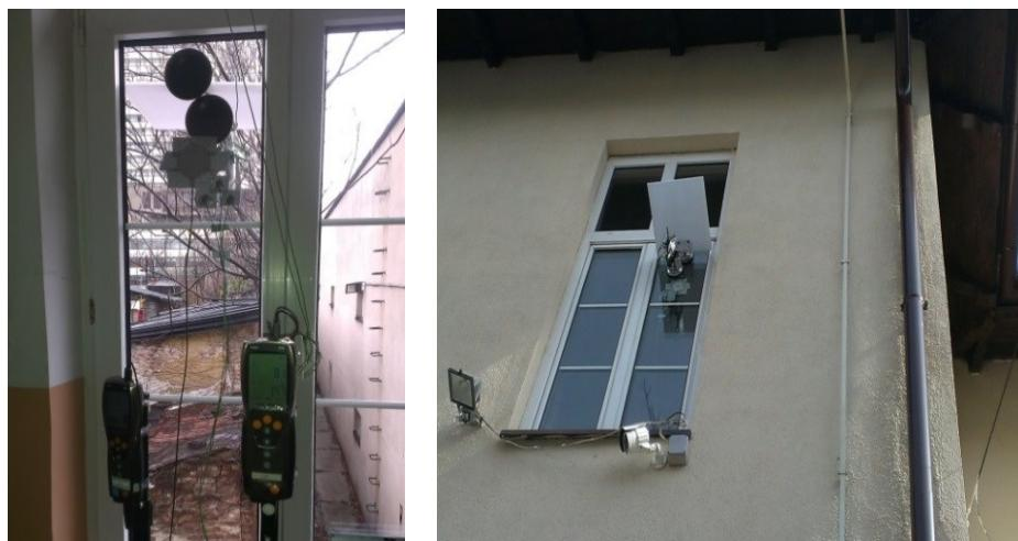
Слика 4.12 Приказ мерења топлотног флукса и температура за стакло (слика лево - унутрашње мерење, слика десно - спољашње мерење)
