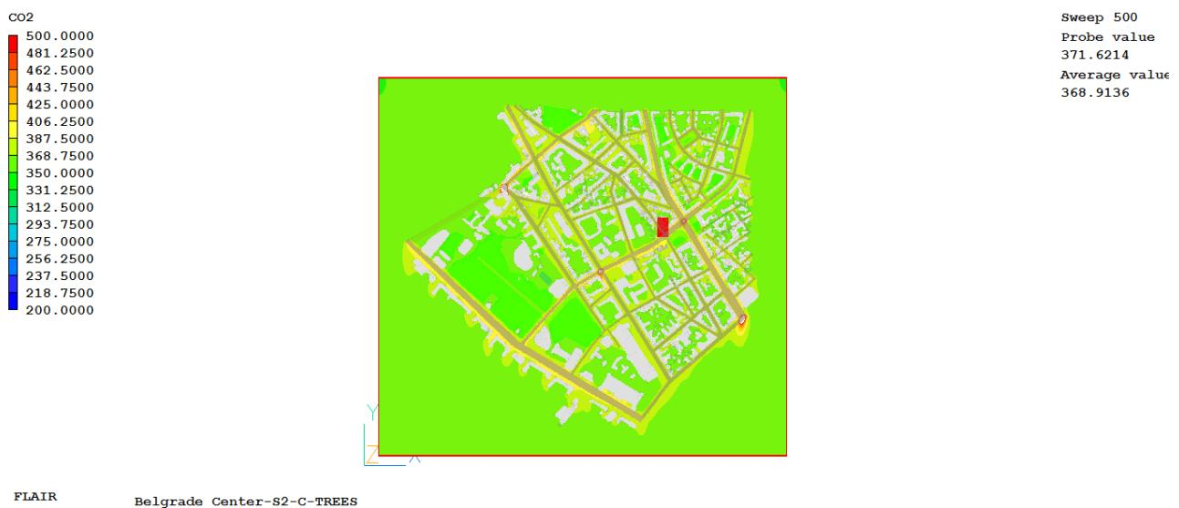
Слика 6.13 Поље концентрације угљен-диоксида у ваздуху на висини 1,85 метара за случај S2-C
